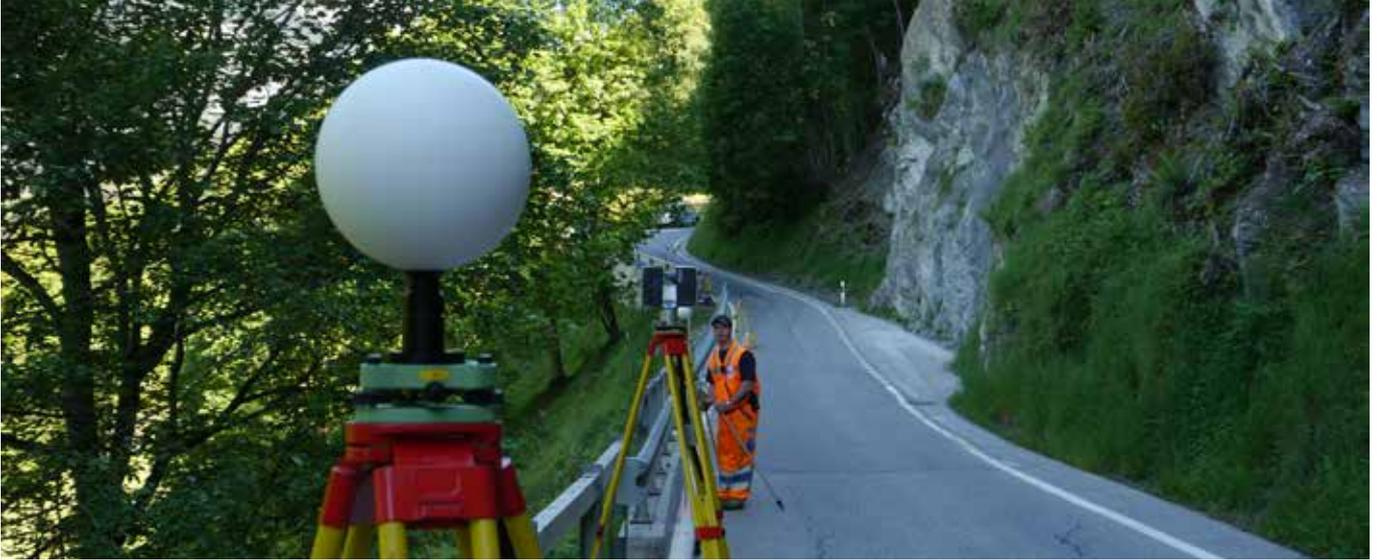
Für die Planung und Ausführung technischer Schutzmassnahmen hat die HMQ AG die Gebiete Acla Hans und Crap Camutsch, oberhalb der Pignierstrasse in Ilanz, mit 3D-Laserscanning vermessen.
